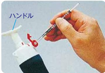
**1** 検知管の両端をチップカッターでキズを付け、折ります。
