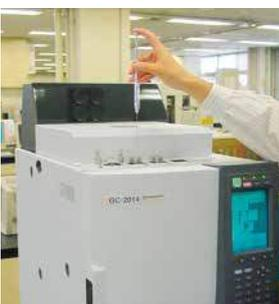
濃縮媒体を充填したGCインジェクション用注射針 AP-20Nにて試料空气中的測定対象物質を捕集、濃縮してGC分析
