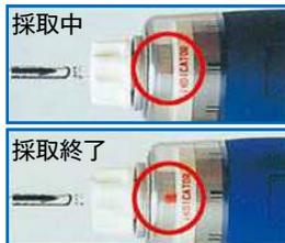
**4** 試料ガスを採取します。(採取の終了はフローインジケータが飛び出してから5秒程度待ってください。)
