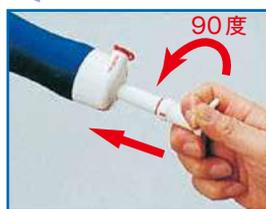
●試料採取量が200mL以上の場合、ハンドルのロックを外し、押し戻し、3の操作から繰り返してください。
