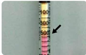
**5** 検知管を取り外し、すぐに変色層先端で濃度を読み取ります。
