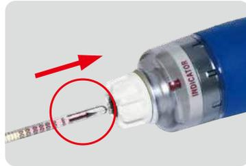
**2** 検知管の矢印をガス採取器に向けて取り付けます。
