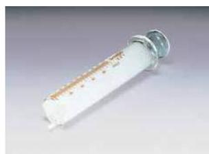
瞬間値・高温ガス・高濃度ガスを測定する場合に使用します。
